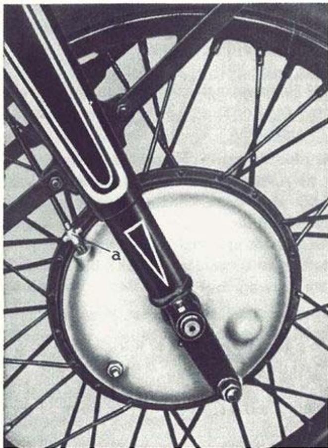
Abb. 10. Vorderradbremse
